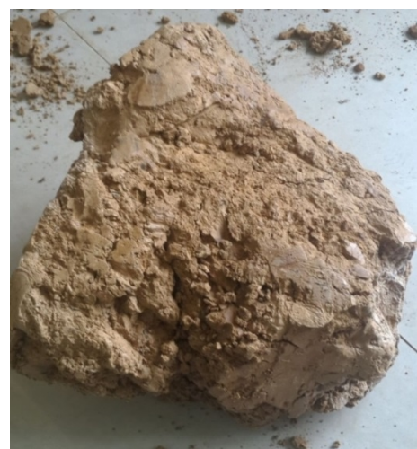
图 1 边坡开挖处原状土样
